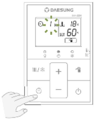
3. При помощи кнопки «Регулировка» можно настроить нужный промежуток времени между запусками котла.
