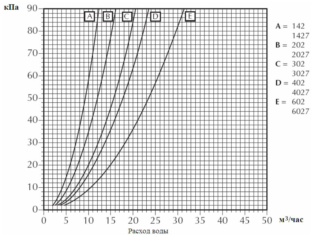
**ТАБЛИЦА 2. ПАДЕНИЕ ДАВЛЕНИЯ В КОНДЕНСАТОРЕ (NBW)**
