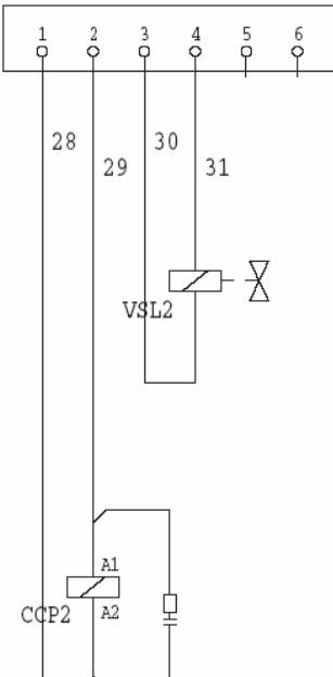
подключение к конденсаторному агрегату с одной цепью вентилятора
