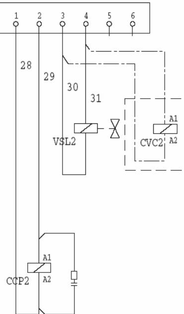
подключение к конденсаторному агрегату с двумя цепями вентиляторов
