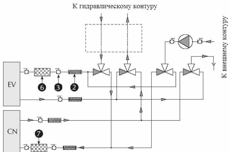
На схемах, относящихся к тепловым насосам, в местах, обведенных штриховой линией, рекомендуется разместить оборудование, обведенное штриховой линией на схеме, относящейся к холодильной машине, работающей только на охлаждение.
