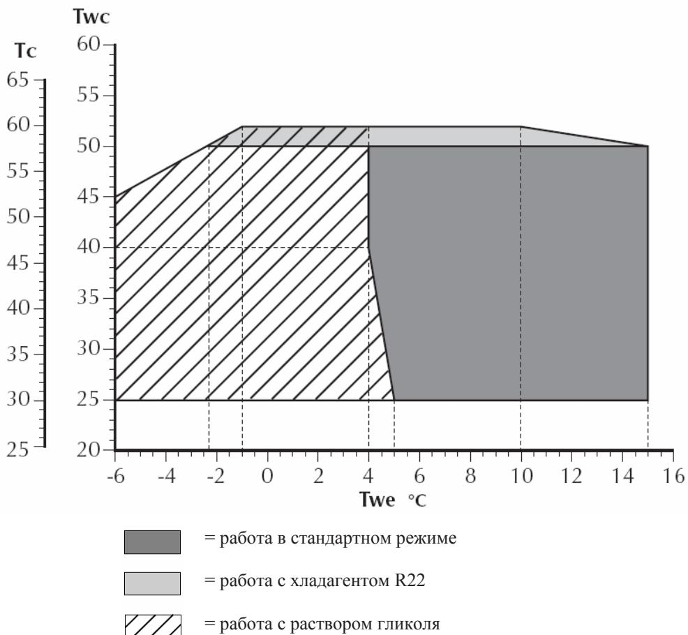
Приведенная диаграмма рассчитана для разности температур  $\Delta t = 5^{\circ}\text{C}$  в испарителе и конденсаторе и относится к холодильным машинам с конденсатором.
