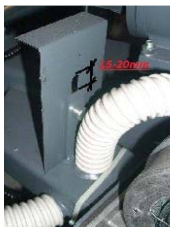
Положение направляющей воздушной заслонки системы безопасности
