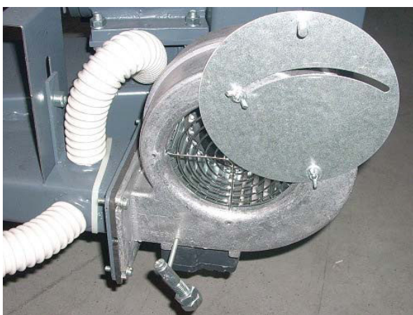
Положение макс. открытой воздушной заслонки вентилятора
