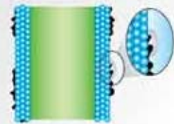
Гидрофильное покрытие ребра приводит к выпадению мелкодисперсных капель конденсата и тем самым способствует удалению пыли
