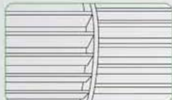
Смещенное расположение лопаток рабочего колеса для снижения шума.
