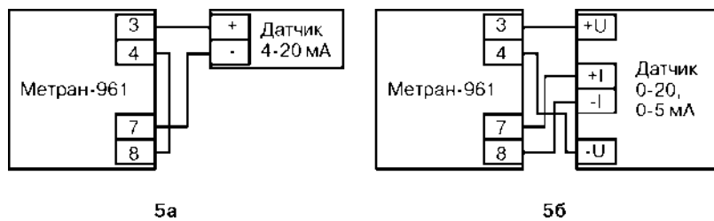
Рис.5. Подключение датчиков по 2-х-проводной (5а) и 4-х-проводной (5б) схемам.
