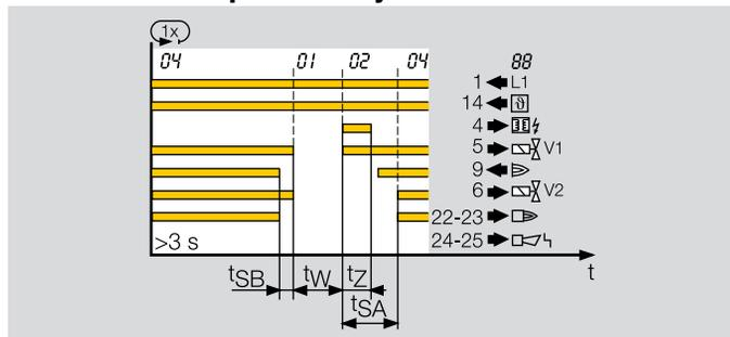
Если IFD 454 обнаруживает пропадание пламени после того, как горелка проработала в течение не менее 3 секунд, клапаны закрываются, и аварийные сигнальные контакты (клеммы 22 - 23) в пределах времени безопасности работы горелки  $t_{SB}$  размыкаются.
