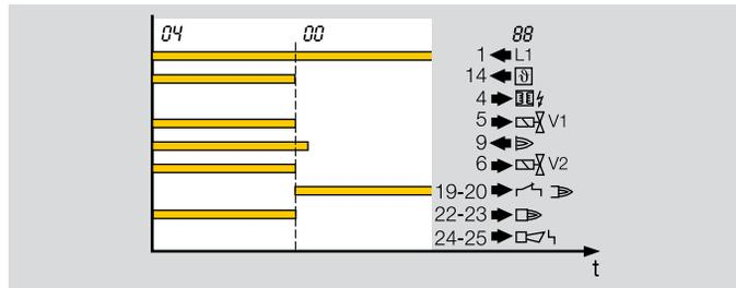
После отключения сигнала запуска ( $\vartheta$ ), клапаны закрываются, управляющие сигнальные контакты между клеммами 22 и 23 размыкаются. Горелка отключается. Автомат управления горелкой IFD проверяет, не присутствует ли сигнал постороннего источника излучения в позиции запуска/готовности к работе. Дисплей показывает текущее состояние программы **00**.
