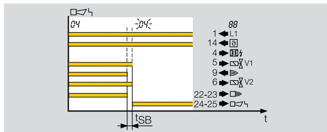
Если пламя пропадает во время работы, клапаны закрыты в течение времени безопасности  $t_{SB}$ .
