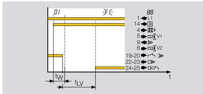
Сообщение об источнике постороннего излучения, обнаруженном по крайней мере одним датчиком пламени, поступает во время запуска (нет контакта между клеммами 19 и 20). В этом случае начинает протекать время задержки постороннего пламени  $t_{LV}$ . Если сообщение об источнике постороннего излучения продолжает поступать в течение времени задержки постороннего пламени  $t_{LV}$  (максимально 15 с), произойдет аварийное отключение. Дисплей мигает и показывает F1.
