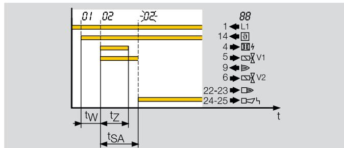
Если после успешного запуска горелки автомат управления не обнаружил сигнала пламени в течение времени безопасности при запуске  $t_{SA}$ , произойдет аварийное отключение (аварийные контакты между клеммами 24 и 25 замыкаются). В течение всего времени безопасности при запуске  $t_{SA}$ , пилотный газовый клапан V1 открыт. Дисплей мигает и показывает  $02$ .
