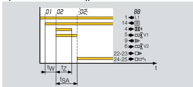
Как только поступает сигнал запуска ( $\delta$ ), начинает протекать время ожидания  $t_W$ . В этот период проводится самотестирование на обнаружение неисправностей внутренних и внешних компонентов системы безопасности. Если в течение этого периода неисправностей не обнаружено, горелка запускается.
