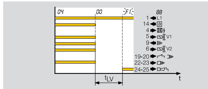
Если сигнал о наличии постороннего пламени поступает по крайней мере от одного датчика пламени, то начинает протекать время задержки постороннего пламени  $t_{LV}$ . Если этот сигнал продолжается в течение всего периода времени  $t_{LV}$  (максимально 15 с) происходит аварийное отключение. Дисплей мигает и показывает **F1**.
