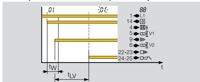
Если сообщение о постороннего пламени поступает в течение запуска, начинает протекать время задержки постороннего пламени  $t_{LV}$ . Если постороннее пламя исчезает в течение времени задержки постороннего пламени  $t_{LV}$  (максимально 15 с), горелка начинает запускаться. В противном случае происходит аварийное отключение. Дисплей мигает и показывает  $01$ .
