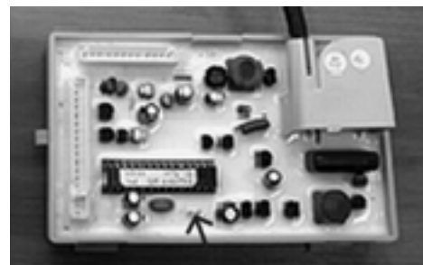
Рисунок 9. Место установки перемычки в регуляторе розжига
