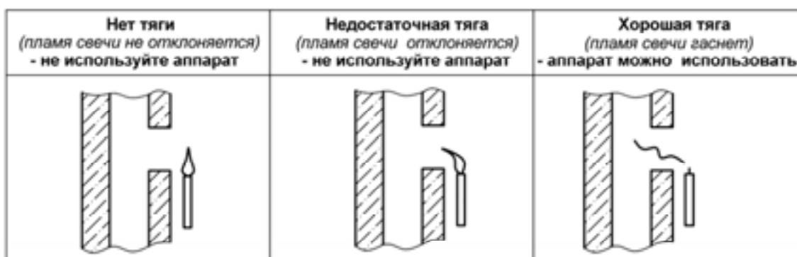
Рисунок 4. Способ проверки тяги в дымоходе
