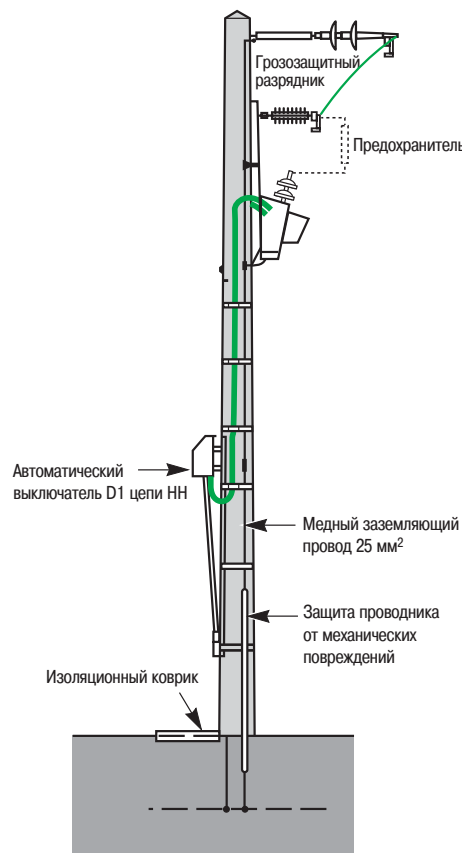
Рис. В55. Трансформаторная столбовая подстанция
