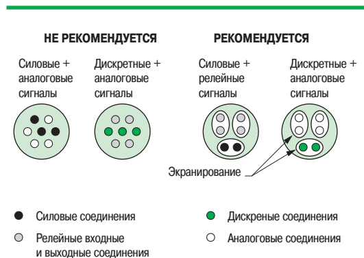
Рис. R40. Несовместимые сигналы = разные кабели
