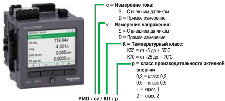
Рис. S9. Идентификация измерительных приборов в соответствии со стандартом МЭК 61557-12 (ГОСТ IEC 61557-12-2015)
