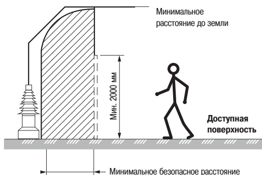
Рис. В14. Защита путем установки барьеров. Безопасное расстояние устанавливается согласно стандарту МЭК 61936
