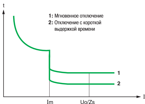
Рис. F18. Отключение системы TN автоматическим выключателем
