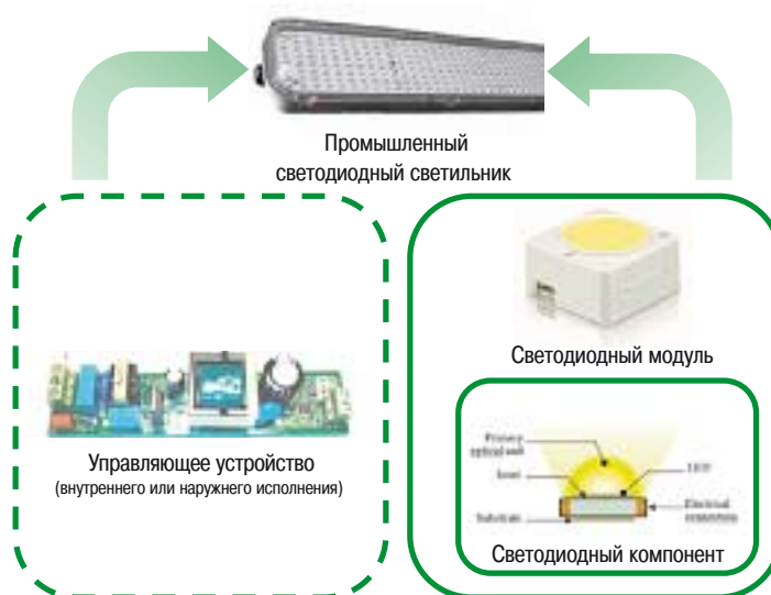
Рис. N51. Светодиод является лишь небольшим элементом конструкции – светодиодной лампы или светильника
