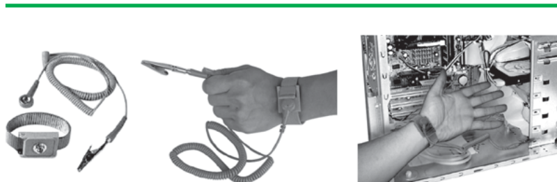
Рис. R26. Пример использования антистатического браслета
