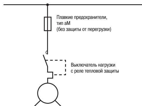
Рис. G41. Цепь защищена плавкими предохранителями aM
