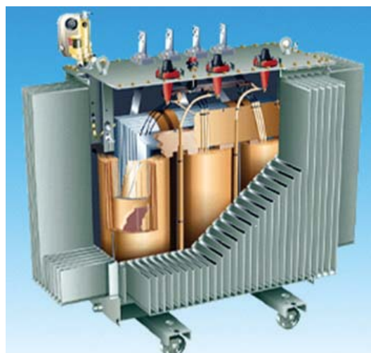
Рис. В17. Трансформатор без расширительного бака
