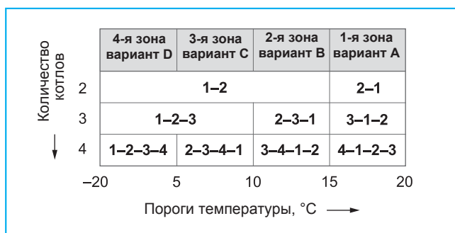
142/2 Последовательность включения котлов через функциональный модуль FM458 в зависимости от наружной температуры
