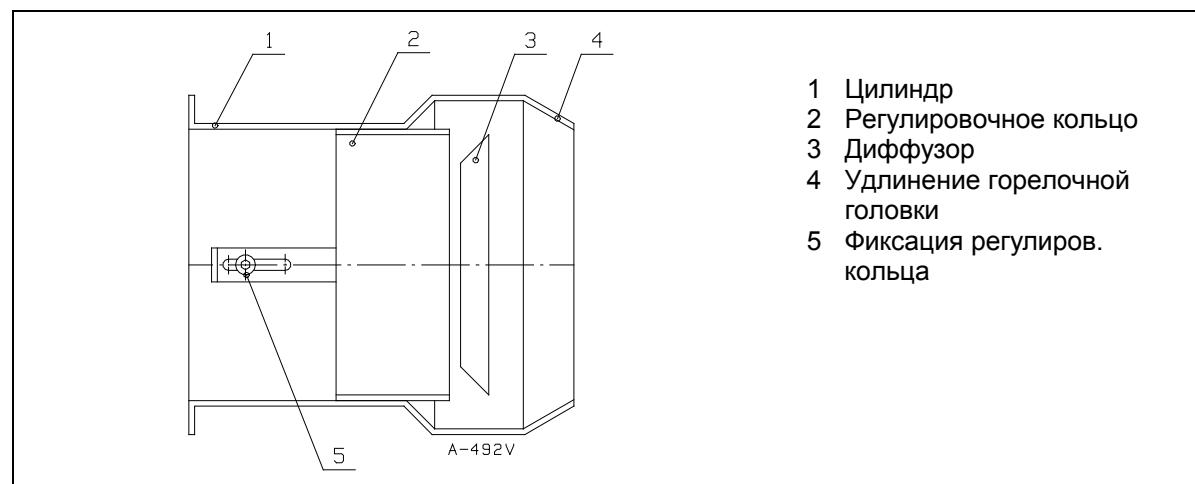
**Вним!** Если место кольца относительно диффузора меняется, также скорость и расход воздуха меняются. Проверьте результат сжигания анализом дымовых газов и подрегулируйте подачу воздуха.
