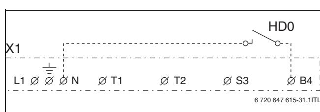
Рис. 26 Схема подключения дистанционного управления
