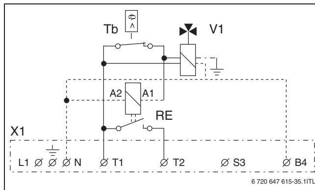
Рис. 32 Трёхходовой клапан с питанием напряжением регулируется замыкающим контактом
