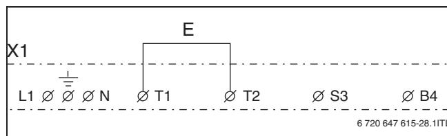
Рис. 28 Включение котла без комнатного регулятора температуры
