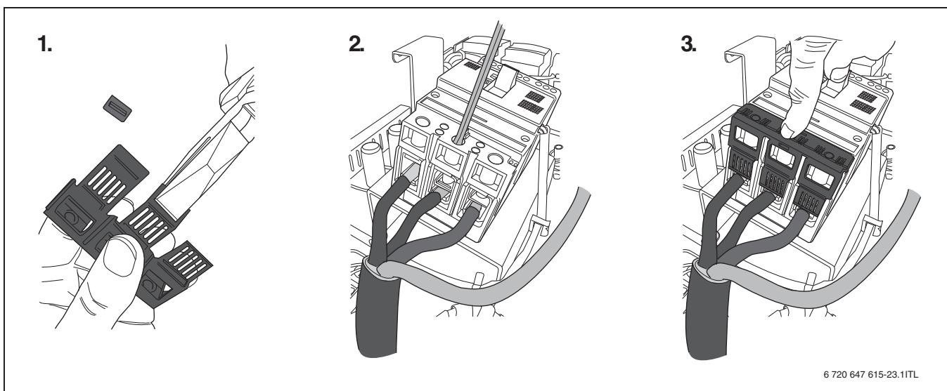
Рис. 10 Подключение электрических проводов (36 – 60 кВт)
