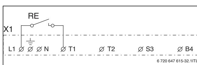
Рис. 30 Схема подключения внешнего включения главного выключателя
