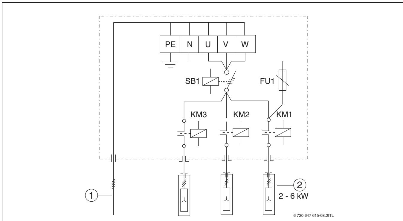
Рис. 18 Электрическая схема Logamax E213 10 – 18
