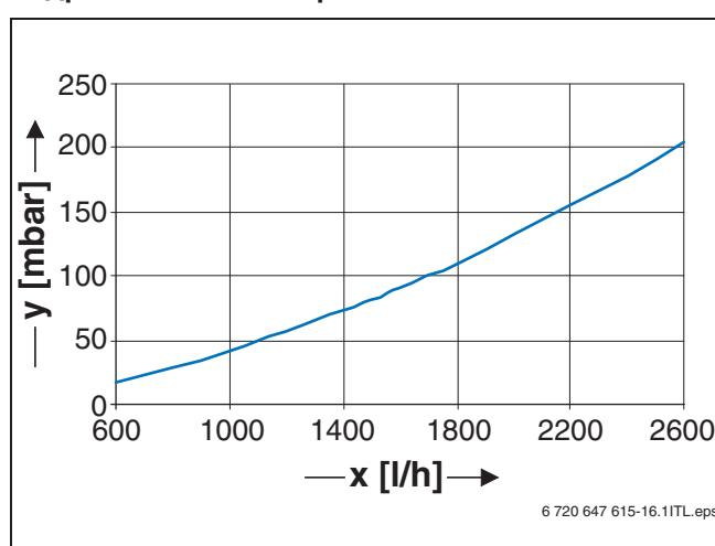
Рис 41 Гидравлическое сопротивление Logamax E213 22 – 60
