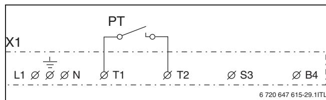
Рис. 25 Схема подключения комнатного регулятора температуры
