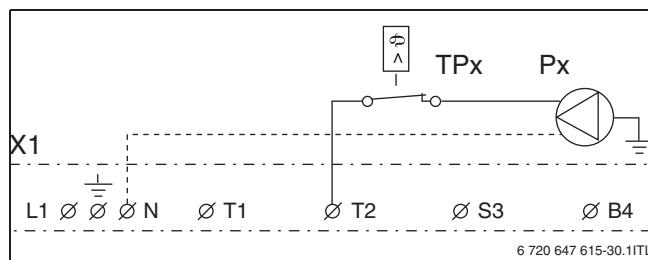
Рис. 29 Схема подключения внешнего насоса с регулятором температуры
