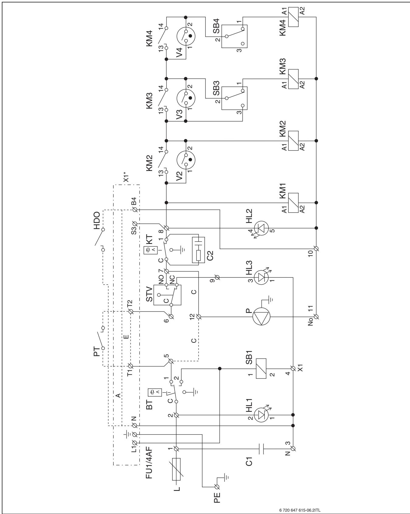
Рис. 15 Электрическая схема Logamax E213 22 – 60 (пояснение условных обозначений → стр. 23)
