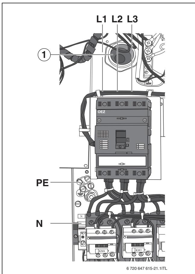
Рис. 8 Подключение сетевого провода 36 – 60 кВт (5-проводная сеть)
