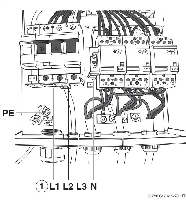
Рис. 7 Подключение сетевого провода 4 – 30 кВт (5-проводная сеть)
