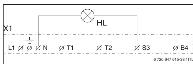
Рис. 27 Схема подключения сигнализации включения «Включение» котла
