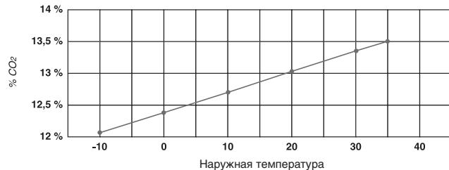
Рис. 20: Диаграмма выбросов CO<sub>2</sub> для горелки BM 1 LN 1
