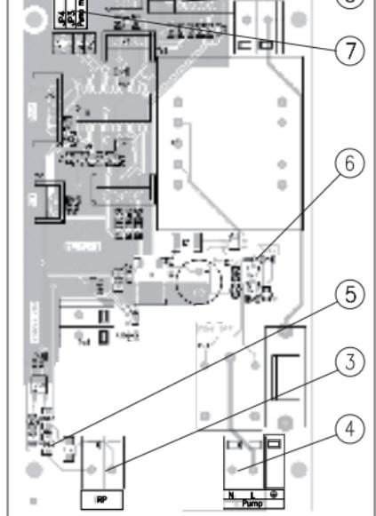
На рисунке представлена плата панели управления котла, к которой можно подключить дополнительное оборудование. На плате имеется также место для осуществления функций конфигурации. Дополнительно сигнализируются некоторые рабочие состояния, что облегчает запуск котла и диагностику правильной работы.
