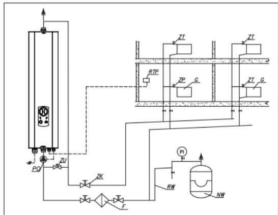
Фильтр следует установить на возврате из отопительной проводки перед входом в котел. Фильтр должен быть установлен горизонтально с обращенной вниз камерой магнитного вкладыша, направление протока должно соответствовать стрелке на корпусе фильтра.
