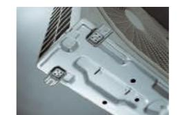
Поддон наружного блока изготовлен из оцинкованной стали повышенной коррозионной стойкости. Это обеспечивает более надежную защиту от коррозии и царапин по сравнению с обычной окрашенной сталью.
