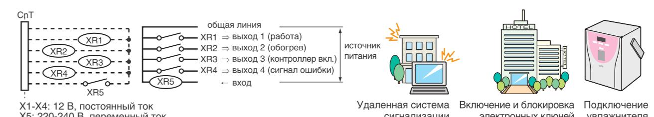
Разъем СНТ предназначен для сигнализации и внешнего управления работой кондиционеров при помощи сухих контактов.
