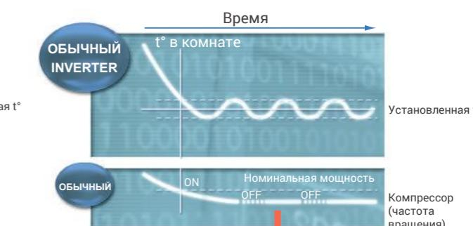
Менее передовая технология не регулирует циклы ВКЛ/ВЫКЛ.
