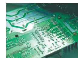
Плата микропроцессора защищена специальным силиконовым слоем, обеспечивающим защиту от влаги и больший срок службы.
