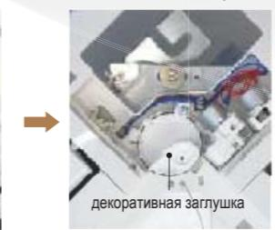
Снимите декоративную заглушку и проверьте состояние дренажного поддона. Если требуется чистка, то вначале снимите резиновую пробку, чтобы слить воду, а затем дренажную крышку (пробку).
