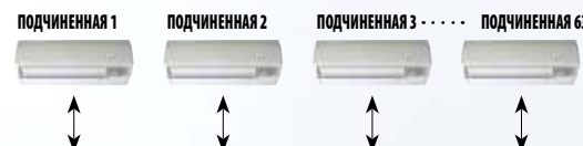
УПРАВЛЕНИЕ ВЕДУЩИЙ/ПОДЧИНЕННЫЙ ДО 64 БЛОКОВ НА ОБЩЕЕ РАССТОЯНИЕ ДО 1200 м
