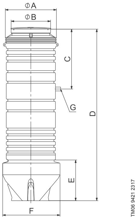
Рис. 42 Габаритный чертёж станции
