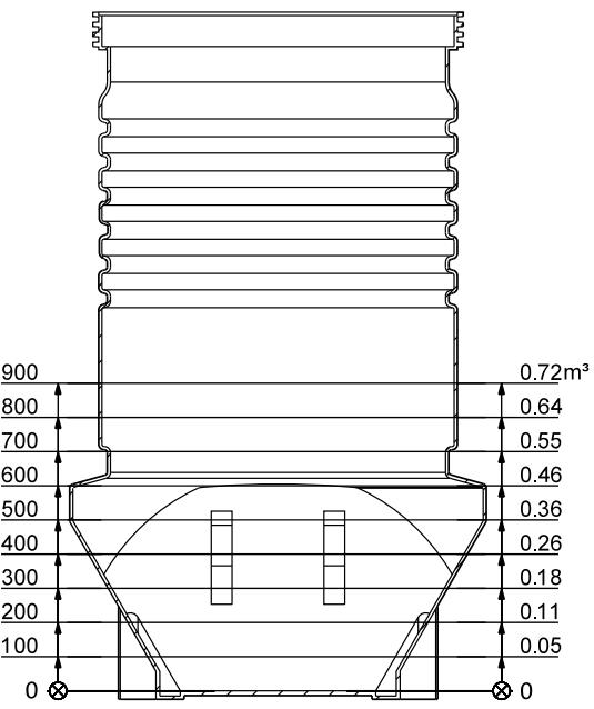
**Рис. 40** Полезный объём относительно уровня, PS.R.12 (два насоса)
