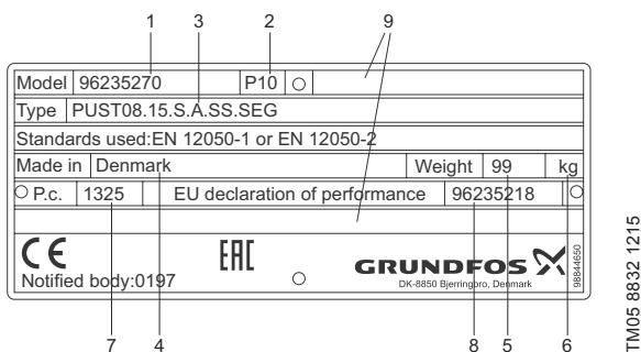
Рис. 4 Фирменная табличка, PS.R.05 - PS.R.17
