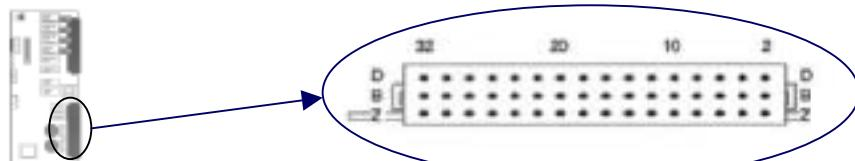
Нумерация контактов разъема в соответствии с DIN41612
