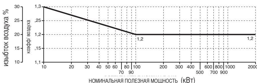
**ВНИМАНИЕ:** Для правильного регулирования процесса сгорания и теплопроизводительности необходимо произвести анализ дымовых газов с применением соответствующих приборов.
