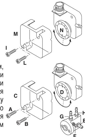
**Внимание:** Давление в гнезде **E** должно находиться в пределах рабочего диапазона реле. В противном случае ослабить блокировочную гайку винта **F**, затем вращая его (по часовой стрелке для уменьшения давления и против часовой стрелки - для его увеличения) произвести требуемое регулирование . По завершении регулирования затянуть гайку.
