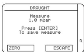
Нажать **FI "ZERO"** – «ОБНУЛЕНИЕ» для переустановки индикации дисплея.
