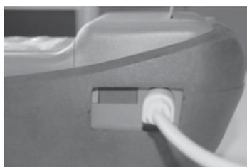
Зонд измерения температуры окружающей среды
