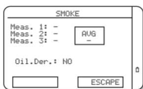
Чтобы не допустить образования конденсата внутри дымового насоса, следует сначала впустить в прибор обычный воздух помещения у горелки перед взятием пробы дыма (не в соединительной трубе выхлопного газа), не используя при этом бумажный фильтр. После этого следует установить фильтр в насос. Пробу дымового газа следует брать из центра потока газообразных продуктов сгорания. Правильный объем дымового газа отбирается выполнением 10 одинаковых всасываний насосом.
