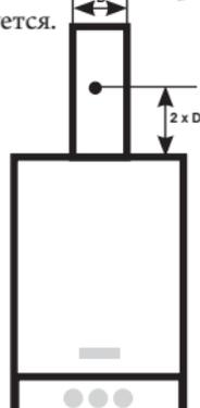
Тягу можно измерить при помощи зонда внешнего давления.
