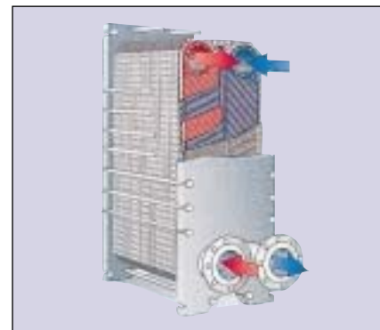
Рис. 1. Сварной пластинчатый теплообменник представляет собой пакет металлических пластин с шевронной гофрировкой, имеющих отверстия для входа и выхода двух рабочих сред. Теплообмен происходит через тонкие пластины из нержавеющей стали, высоколегированной нержавеющей стали или титана, что обеспечивает высокую эффективность работы теплообменника.
