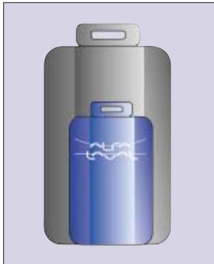
Рис. 4. Полуварной пластинчатый теплообменник компактнее и вмещает меньше хладагента, чем традиционный теплообменный аппарат для той же производительности и назначения.
