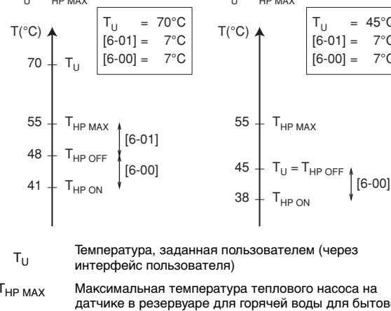
**ПРИМЕЧАНИЕ** Величина  $T_{HP MAX}$  имеет теоретическое значение. В действительности тепловой насос способен нагреть резервуар максимум до 53°C. Чтобы повысить производительность теплового насоса в режиме нагрева воды бытового потребления, рекомендуется задать значение параметра  $T_{HP OFF}$  не выше 48°C.
