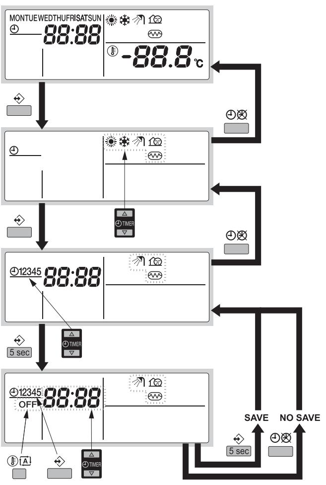
Программирование нагрева воды для бытового потребления, вспомогательного нагрева и тихого режима осуществляется следующим образом.
