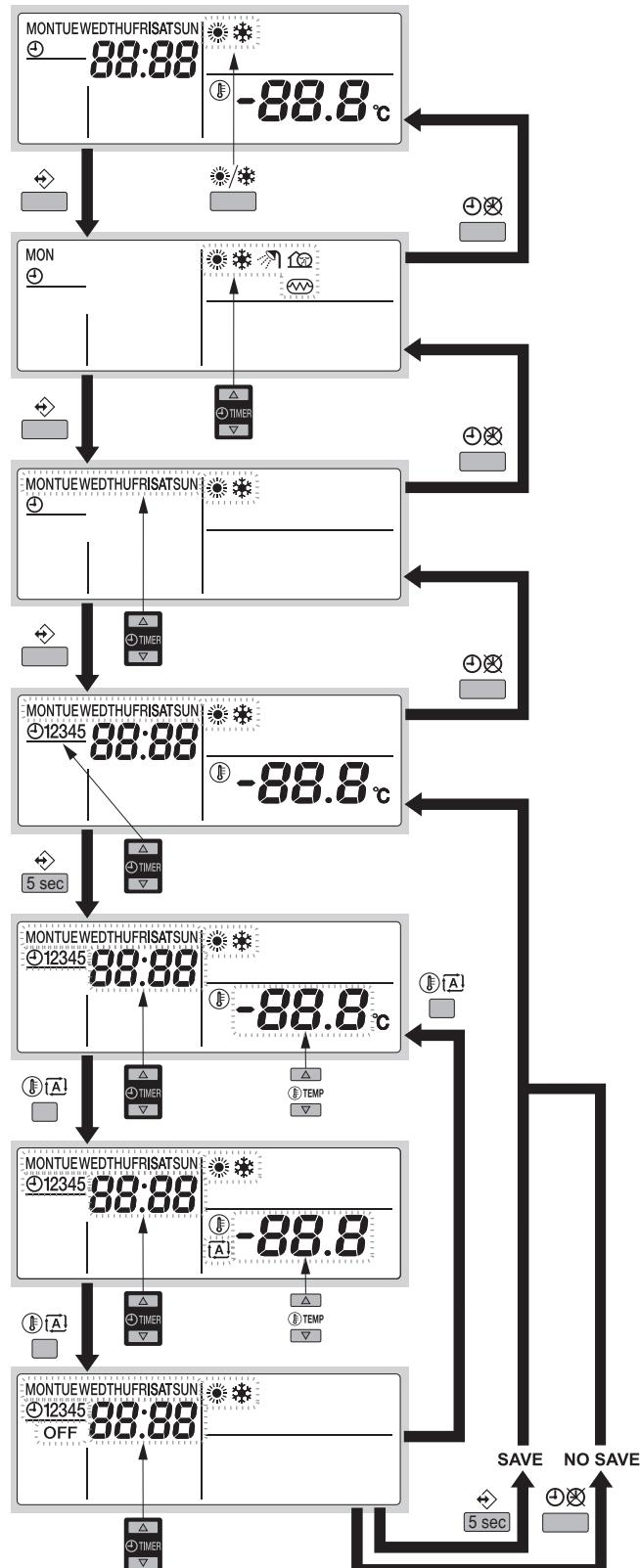
**ПРИМЕЧАНИЕ** Охлаждение помещения и обогрев помещения программируются одинаково. В начале процедуры программирования выбирается охлаждение помещения или обогрев помещения. После этого следует вернуться к началу процедуры программирования и запрограммировать другой режим работы.
