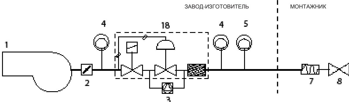
Газовая рампа с группой клапанов MBC 1900/3100/5000SE(2 клапана + газовый фильтр + стабилизатор давления + реле давления) + блок контроля герметичности VPS504
