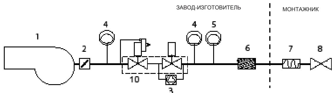
Газовая рампа с группой клапанов MBC 1200 SE (2 клапана + газовый фильтр + стабилизатор давления + реле давления) + блок контроля герметичности VPS504
