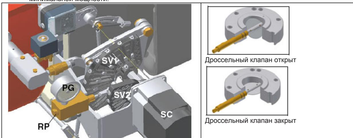
12. Для того, чтобы отрегулировать по точкам варьируемый сектор, перевести микровыключатель малого пламени (кулачок III) слегка ниже значения максимальной мощности ( $90^\circ$ ).
