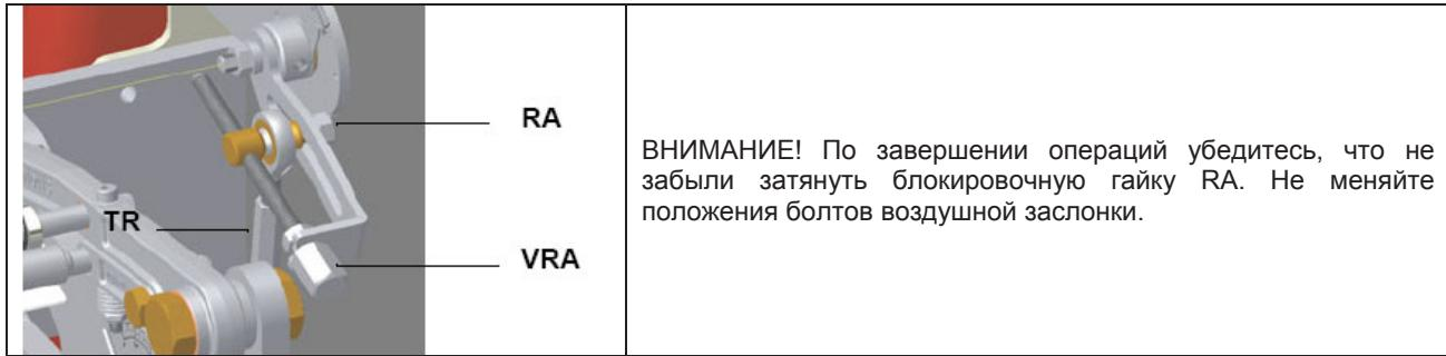
10. Регулировать положение головы сгорания только в случае необходимости: для работы на сниженной мощности расслабить винт VB и постепенно сдвигать голову сгорания в сторону положения "MIN", вращая по часовой стрелке регулировочное кольцо VRT. Заблокировать винт VB при завершении регулировки.
