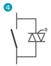
Отключение: полупроводник становится непроводящим
