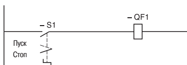
Двухпроводное управление при помощи двухпозиционного переключателя
