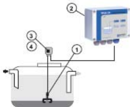
Рисунок 1: Система аварийной сигнализации сборника (уловителя) песка
