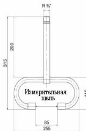
Рисунок 6: Габаритный чертеж для зонда WGA-SN
