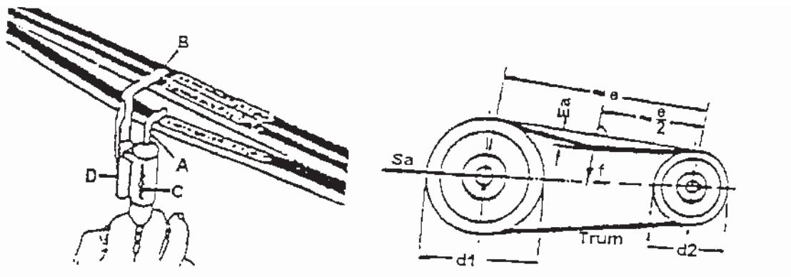
Крюк нагрузки А измерительного прибора поместить в середину ветви. Привести в позицию указатель тяги В. Установить на шкале С контрольную силу. Для этого тянуть измерительный прибор под прямым углом к ветви. На шкале D указывается глубина вдавливания. Смещение в случае необходимости корректировать до достижения заданной глубины вдавливания  $E_a$ .
