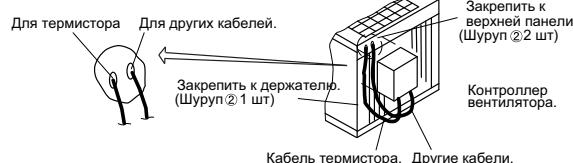
3. Кабель для контроллера вентилятора проходит через отверстия п. 2.
