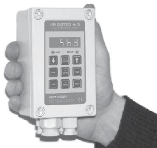
Высокоточный гигростат промышленного применения Air Man предназначен для управления процессом осушения и/или увлажнения. Контроллер состоит из электронного блока Air Man и датчика влажности SmartSens 3000 с кабелем. Алгоритм управления основан на замере относительной влажности датчиком с последующим сравнением замеренных или расчетных (точка росы) данных с заданной уставкой. Программирование контроллера осуществляется посредством простой и удобной клавиатуры.
