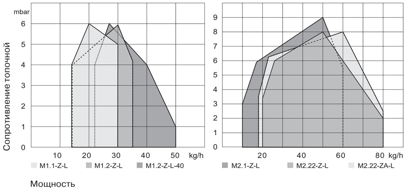
Рабочие зоны согласно DIN EN 267. Рабочие зоны определены для высоты прим.200 м. над уровнем моря и температуре помещения 20°C.
