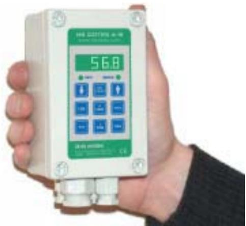
Высокоточный гигростат промышленного применения Air Man предназначен для управления процессом осушения и/или увлажнения. Контроллер состоит из электронного блока Air Man и датчика влажности SmartSens 3000 с кабелем. Алгоритм управления основан на замере относительной влажности датчиком с последующим сравнением замеренных или расчетных (точка росы) данных с заданной уставкой. Программирование контролера осуществляется посредством простой и удобной клавиатуры.
