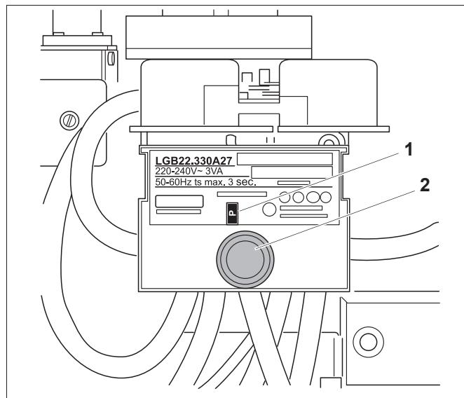
Рис. 35 Блок управления LGB 22; передняя сторона автомата
