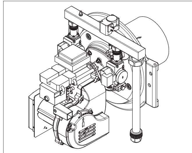
Рис. 4 Объем поставки; газовая горелка с предварительным смешиванием Logatop VM
