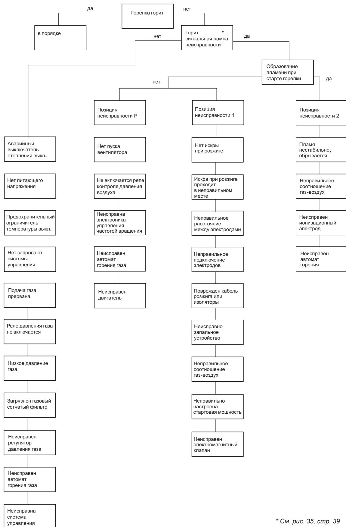
Рис. 36 Функциональная диаграмма устранения неисправностей
