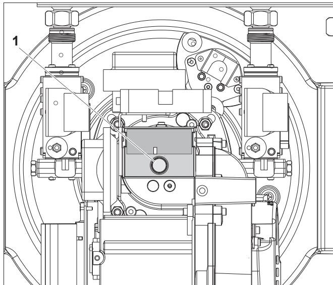
Рис. 3 Кнопка подавления помех с лампочкой сигнализации неисправности
