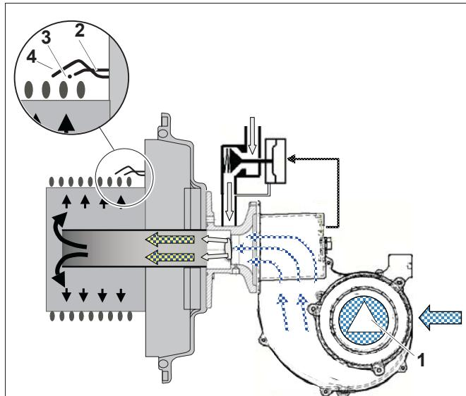
Рис. 2 Работа газовой горелки с предварительным смешиванием, разрез
