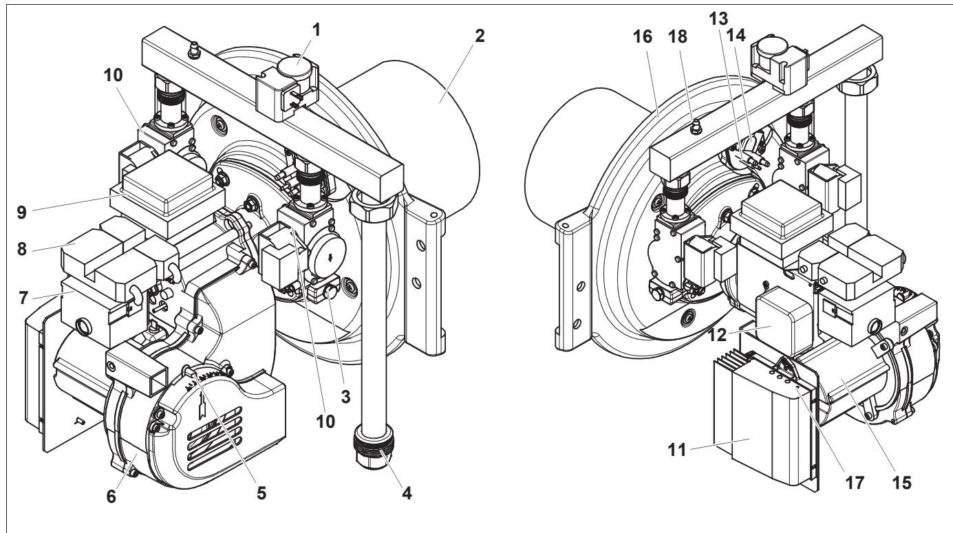
Рис. 1 Горелка Logatop VM, вид справа и слева
