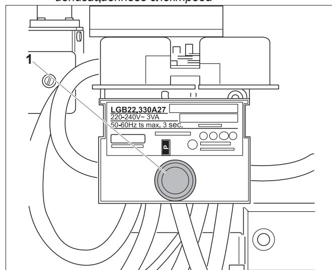
Рис. 18 Кнопка подавления помех со встроенной сигнальной лампочкой.
