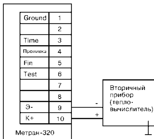
Рис. 1. Схема подключения расходомера Метран-320 к вторичному прибору.
