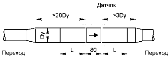
Рис.4. Установка в газопровод (паропровод) меньшего Dy.
