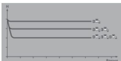
Работа TECHNOTIMER - стабильное давление в системе при неизменном потреблении воды.
