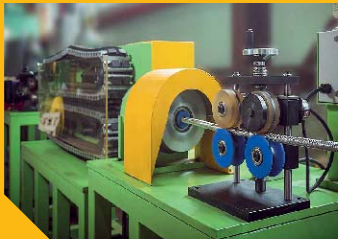
Процесс гофрирования трубы
