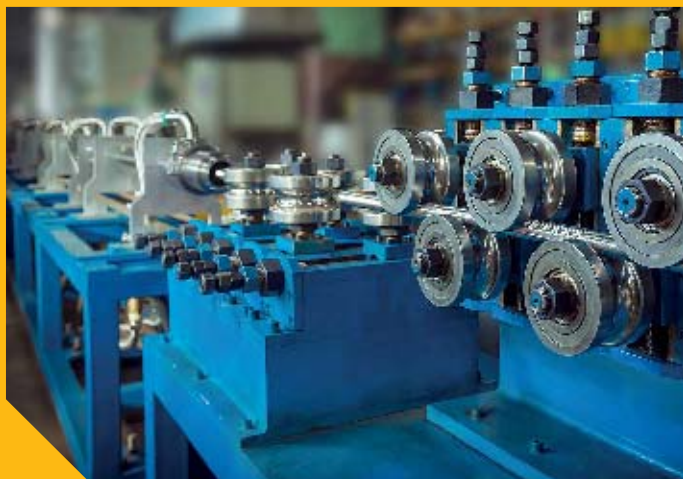
Линия охлаждения гофрированной трубы Stahlmann после отжига
