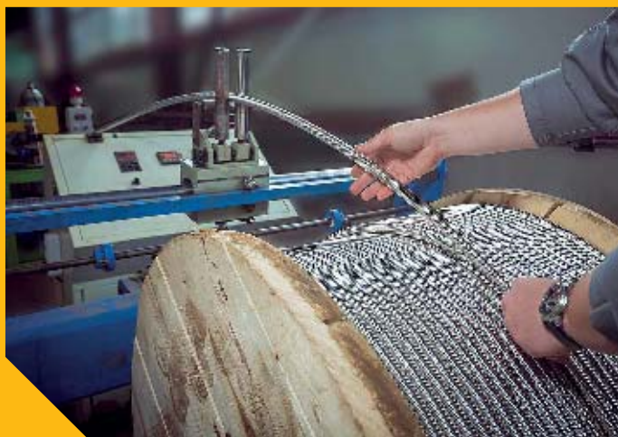
Подача гофрированной трубы Stahlmann для отжига
