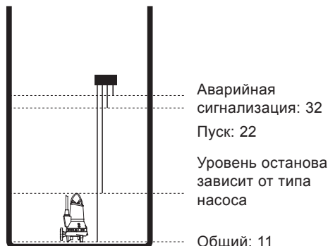
Рис. 23 Электроды в канализационном резервуаре, оборудованном одним насосом
