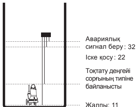
23-сур. Бір сорғымен жабдықталған кәріздік сұйыққоймадағы электродтар
