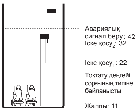
24-сур. Екі сорғымен жабдықталған кәріздік сұйыққоймадағы электродтар
