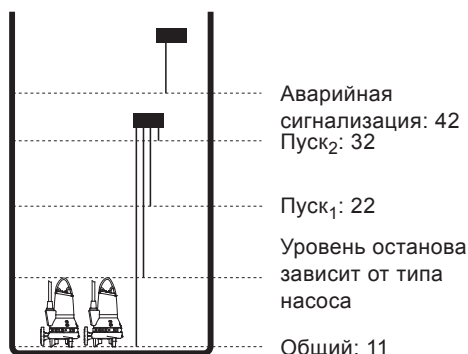
Рис. 24 Электроды в канализационном резервуаре, оборудованном двумя насосами
