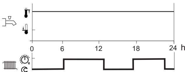
**Установка 1:** В зависимости от локальной программы отопления, но на один час вперед. Нагрев воды происходит на основе выбранной программы отопления. Время переключения сдвигается на 1 час вперед. Выключается при выключении системы отопления.
