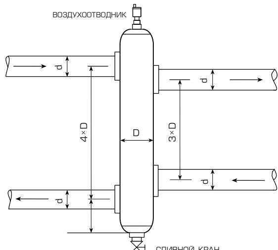
Диаметр гидравлического разделителя, подводящих и отводящих труб показаны в таблице в зависимости от термической мощности каскада.
