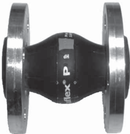
Рис. 19 Вибровставка с резиновыми прокладками без ограничительных стяжек
