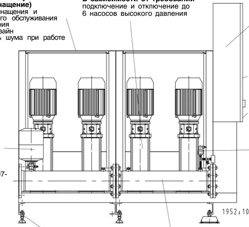
**Монтажная сборка, исключающая появление корпусного шума** благодаря разъединению насосов
