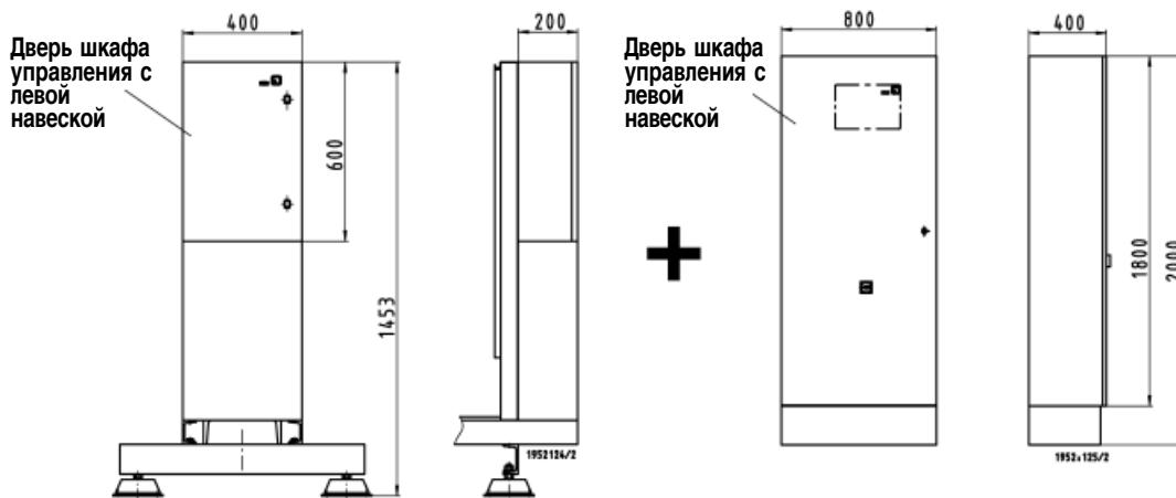
Передаточное устройство управления с одной клеммной колодкой для всех насосов и датчиков.
