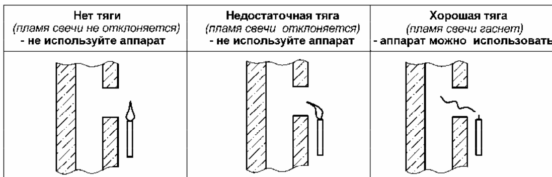
Рисунок 4. Способ проверки тяги в дымоходе
