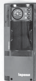
Контрольная панель типа "KP1" Включает термометр регулирующий и предохранительные термостаты, переключатель зима-лето, индикаторы состояния работы прибора и программатор по времени. Поставляется в отдельной коробке с инструкцией.
