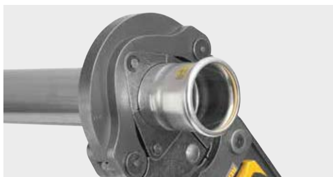
Пресс-шайба REMS (PR-3S) с 3 запрессовочными сегментами, установленными на поворотном шарнирном кольце, для осуществления запрессовок больших размеров, к которым предъявляются особые требования. Оптимальное прессование обеспечивается радиально управляемым движением пресс-сегментов, с промежуточными клещами.
