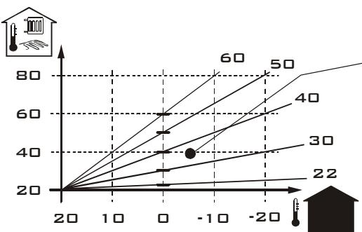
ОТОПИТЕЛЬНАЯ КРИВАЯ электрокотла, в которой по вертикали температура прямой воды и по горизонтали температура наружного воздуха
