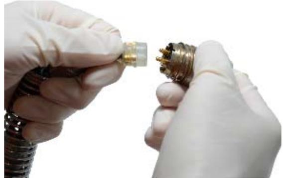
**Рисунок 24 – Отсоединение разъема**
