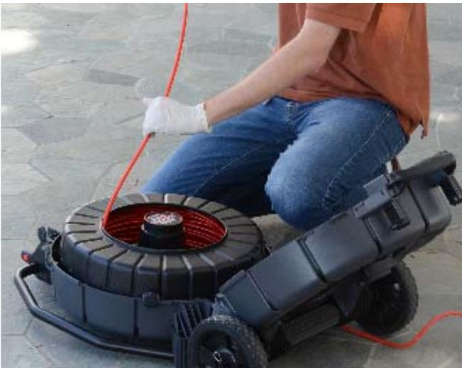
**Рисунок 27 – Как направлять проталкивающий кабель в барабан**
