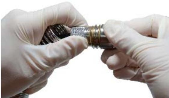
**Рисунок 23 – Демонтаж головки камеры**
