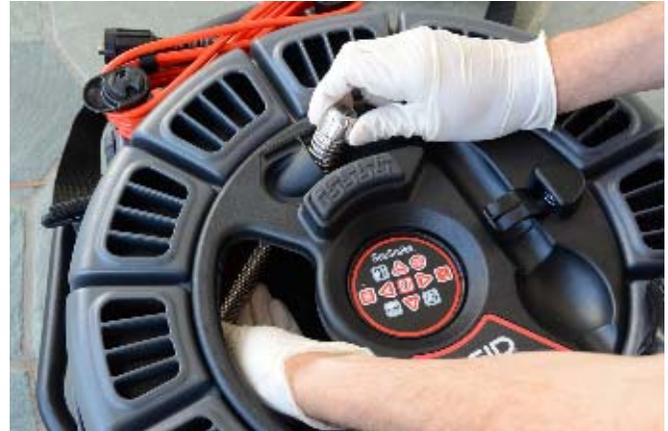
**Рисунок 28 – Укладка головки камеры**
