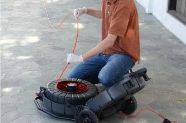
**Рисунок 26 – Вращайте барабан, чтобы правильно намотать проталкивающий кабель**
