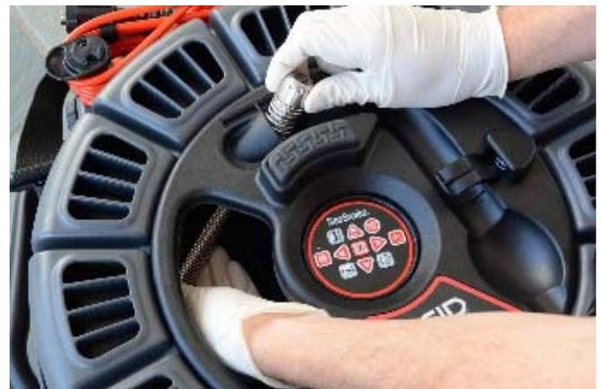
Рисунок 4 – Укладка головки камеры
