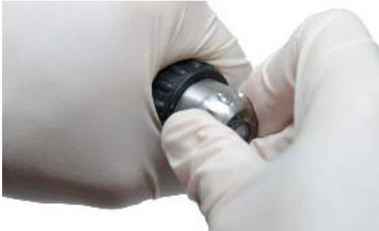
**Рисунок 22 – Выкрутите камеру из пружины**
