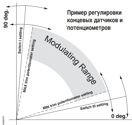
Рис. 13. Установка кулачков и подстроечных потенциометров.
