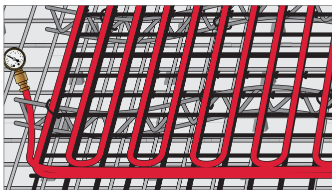
Рис. 8-28 Шаг 4: Произвести испытания сжатым воздухом
