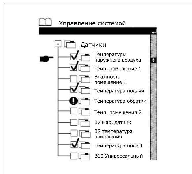
Рис. 7-21 Сервисный уровень – конфигурация датчиков
