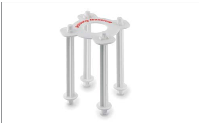
Рис. 5-10 Установка измерения остаточной влажности
