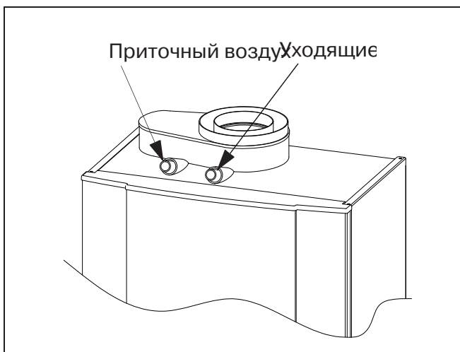
Илл. 14: Точка измерения уходящих газов
