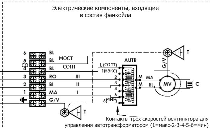
**РАЗЪЕМЫ КЛЕММНОЙ КОЛОДКИ ДЛЯ ПОДКЛЮЧЕНИЯ УДАЛЕННОГО УПРАВЛЕНИЯ
