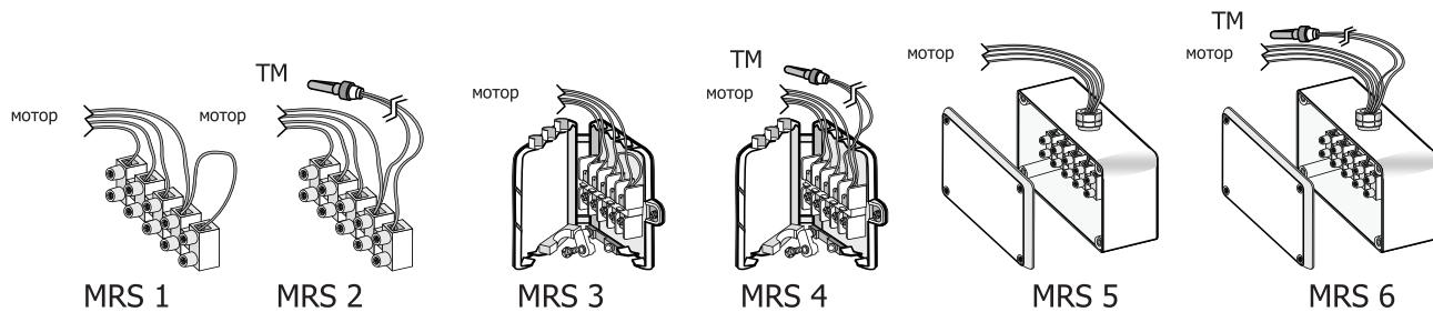
**КЛЕММНЫЕ КОЛОДКИ ДЛЯ СОЕДИНЕНИЯ С ДИСТАНЦИОННЫМ УПРАВЛЕНИЕМ, ПОСТАВЛЯЕМЫЕ В КОМПЛЕКТЕ С ФАНКОЙЛОМ**
