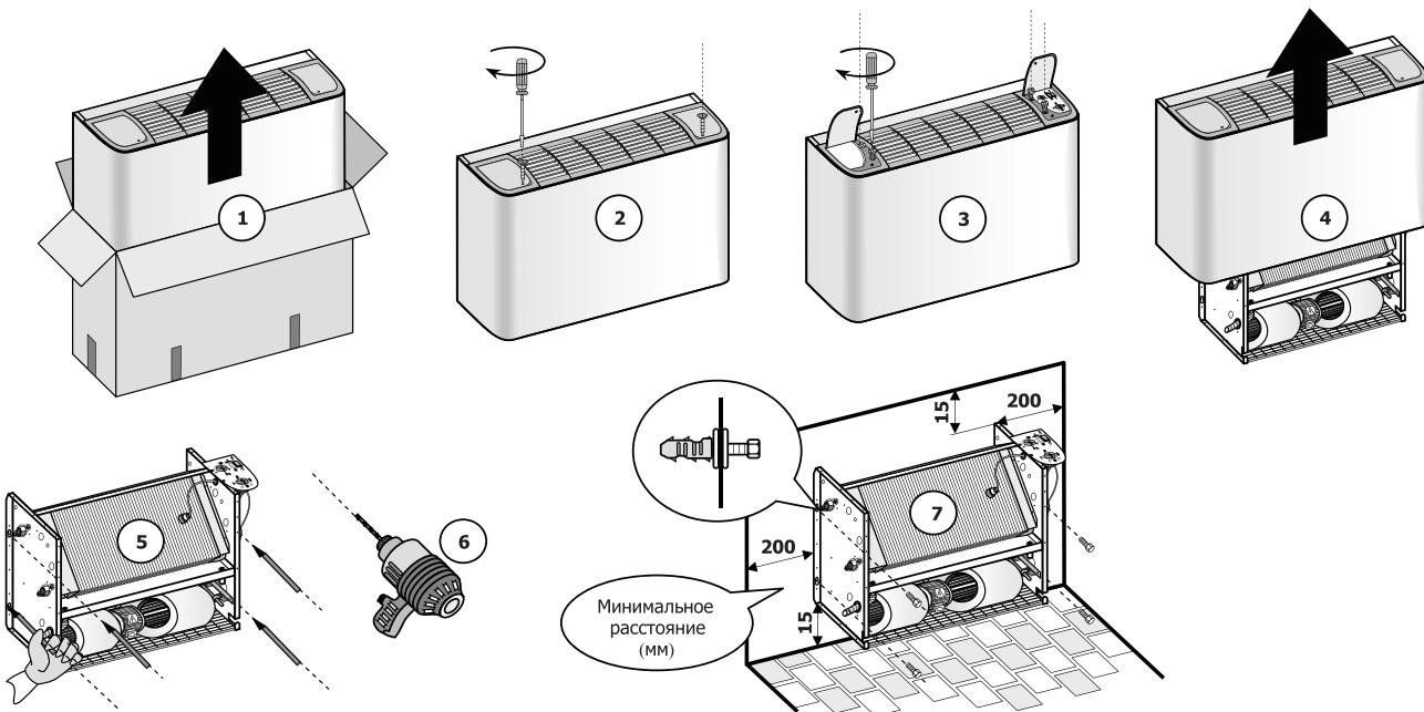
Монтажные размеры и отверстия для фиксации фанкойла при помощи стержней с резьбой M8 и шестигранных гаек H8 или анкеров диаметром 8 мм представлены в таблицах общих данных.
