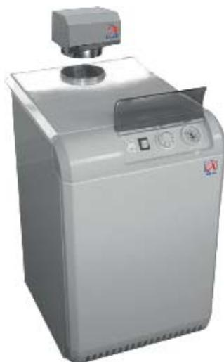
Вытяжные вентиляторы SV являются дополнительными устройствами предназначенными для стационарных котлов ALPHATHERM БЕТА. Вентилятор SV обеспечивает надёжный отвод уходящих газов. Безопасность эксплуатации обеспечивает дифференциальный маностат уходящих газов, который зажжет горелку котла только при условиях полного удаления уходящих газов.
