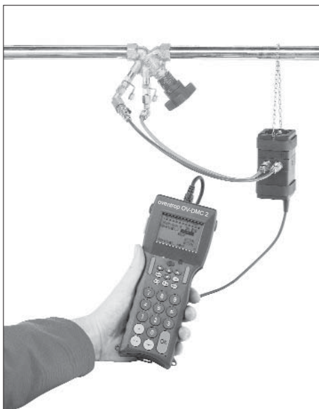
„OV-DMC 2“ арт. № 106 91 77 с регулирующим вентилем „Hydrocontrol R“
