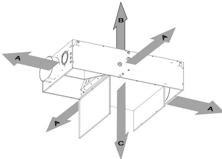
A = 600мм минимум; B = 30мм минимум; C = 20мм + нижняя панель доступа
