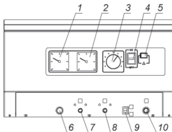
Рисунок 4. Внешний вид панели управления котла ALFA COMFORT E 55; E 60; E 70 .
