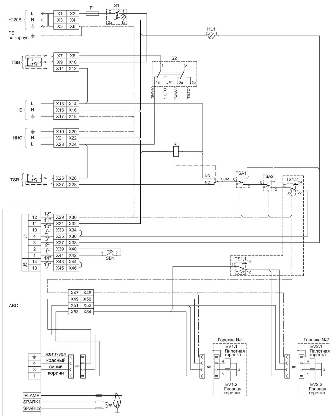
ABC – блок управления газовыми клапанами;
